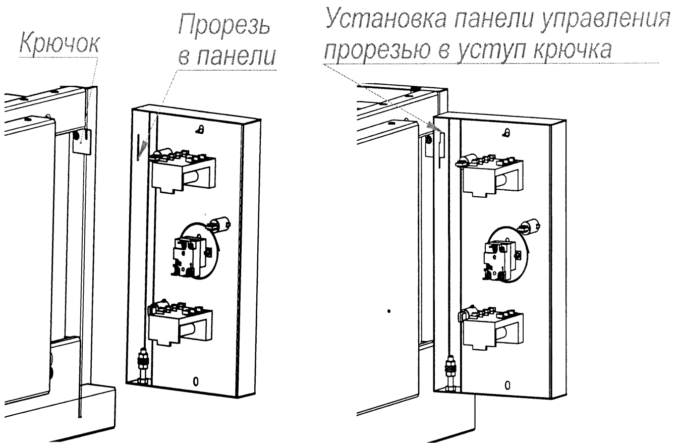
Рис.11. Технологическое окно для замены контрпетли.
